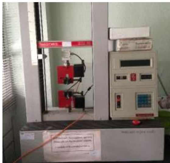
ภาพที่ 3.4 เครื่องทดสอบแรงดึง Tensometric รุ่น Micro 350
