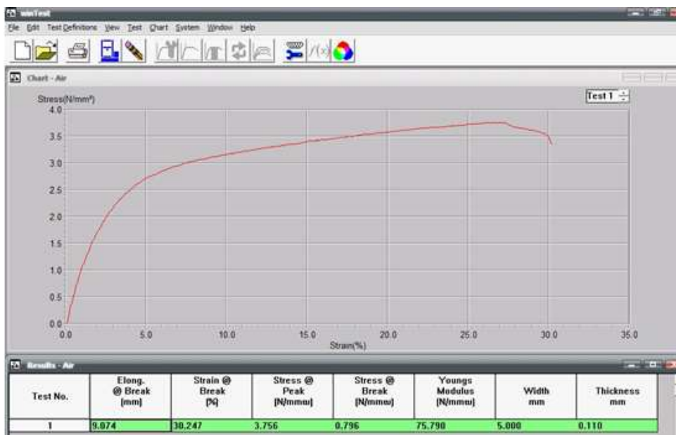
ภาพภาคผนวกที่ 4ค ตัวอย่างภาพสมบัติเชิงกลของฟิล์มซีเอ็มซีจากเปลือกทุเรียนที่ใส่กลีเซอร์อล ร้อยละ 20 โคโมวล (CMC d 20G) จากเครื่องทดสอบแรงดึง
