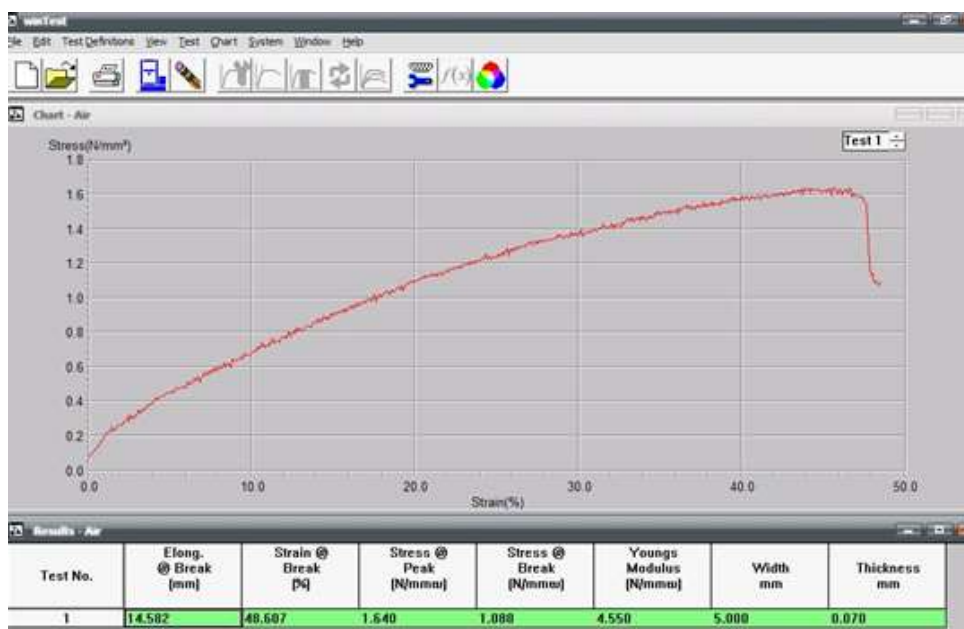
ภาพภาคผนวกที่ 5ค ตัวอย่างภาพสมบัติเชิงกลของฟิล์มซีเอ็มซีจากเปลือกทุเรียนที่ใส่กลีเซอร์อล ร้อยละ 30 โคโมวล (CMC d 30G) จากเครื่องทดสอบแรงดึง
