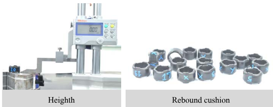
ภาพที่ 4-10 การวัดความสูงรวมของยางรองลูกสูบ
