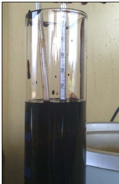
ภาพที่ 3-4 การจุ่มไฮโดรมิเตอร์และเทอร์โมมิเตอร์เพื่อทำการอ่านค่าความถ่วงจำเพาะ (API)
