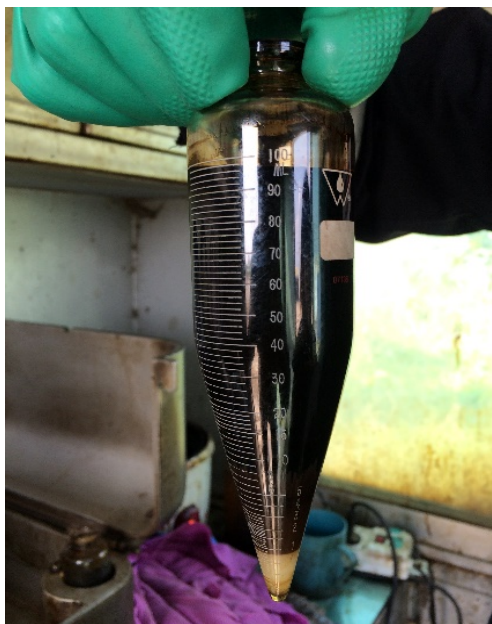
ภาพที่ 3-3 การแยกชั้นระหว่างน้ำมัน น้ำที่แยก และตะกอนที่เกิดจากการหมุนเหวี่ยง
