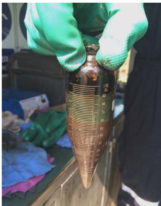
ภาพที่ 3-2 การแยกชั้นน้ำออกจากน้ำมันดิบเมื่อครบ 90 นาที
