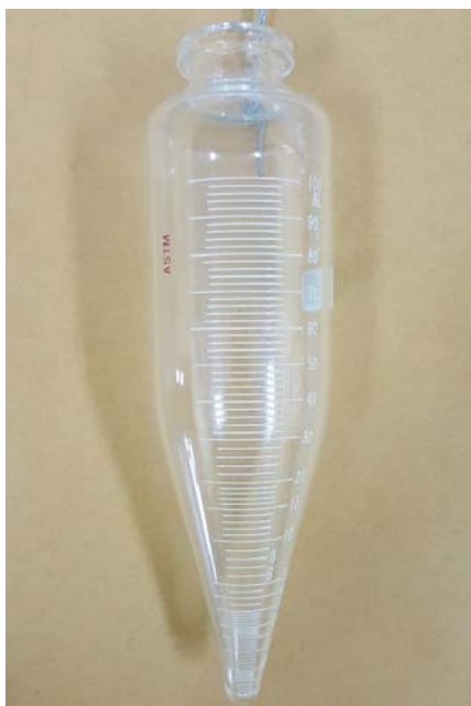
ภาพที่ 3-1 หลอดเซนติฟิว (Centrifuge tube) ขนาด 100 มิลลิลิตร
