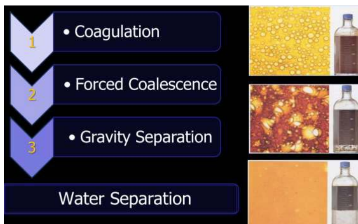
ภาพที่ 2-16 กลไกของคิมัลซิไฟเคชัน (Ben Mahmud, 2009)
