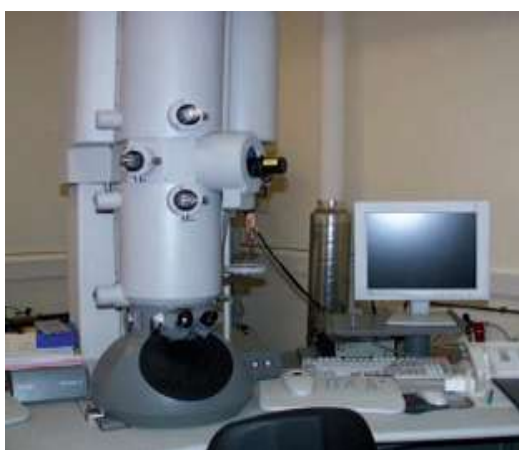
ภาพที่ 3 - 4 กล้องจุลทรรศน์อิเล็กตรอนแบบส่องผ่าน (TEM) รุ่น Tecnai 20 (มหาวิทยาลัยบูรพา, 2558)
