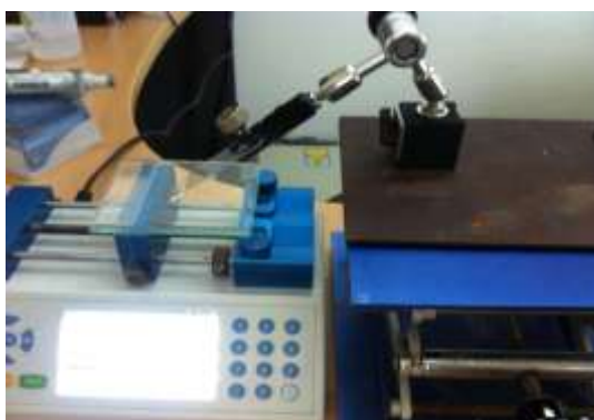
ภาพที่ 2 - 10 เทคนิคการเคลือบฟิล์มบางแบบการนำพาการระเหย
