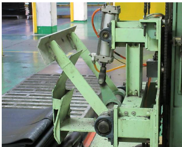
ภาพที่ 4-7 ครอบควบคุมการขึ้นลงของ Pusher
