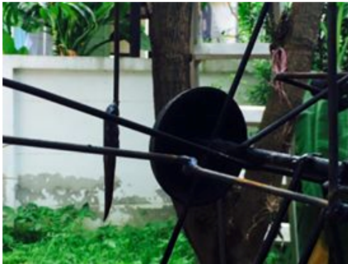
ภาพที่ 3-17 ประกอบเหล็กแหลมที่ใช้แทนเชือกเส้นเข้ากับโครงสร้าง
