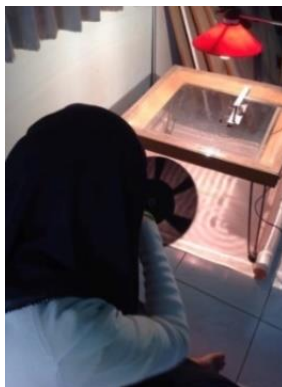
ภาพที่ 3-4 การหาความถี่ของคลื่นน้ำในถาดคลื่นจากสโตรโบสโคป
