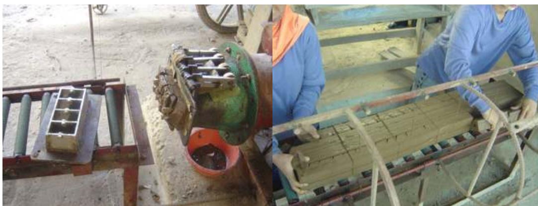
ภาพที่ 34 เครื่องมือที่ประดิษฐ์ขึ้นเพื่อใช้ทุ่นแรงและเพิ่มปริมาณการผลิต
