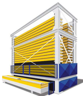
ภาพที่ 2-6 Vertical Lift Storage System สำหรับสินค้าที่มีลักษณะยาวและมีน้ำหนักมาก (ทิวากร แก้วศรี, 2556)
