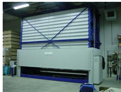
ภาพที่ 2-6 Vertical Lift Storage System สำหรับสินค้าที่มีลักษณะยาวและมีน้ำหนักมาก (ทิวากร แก้วศรี, 2556)
