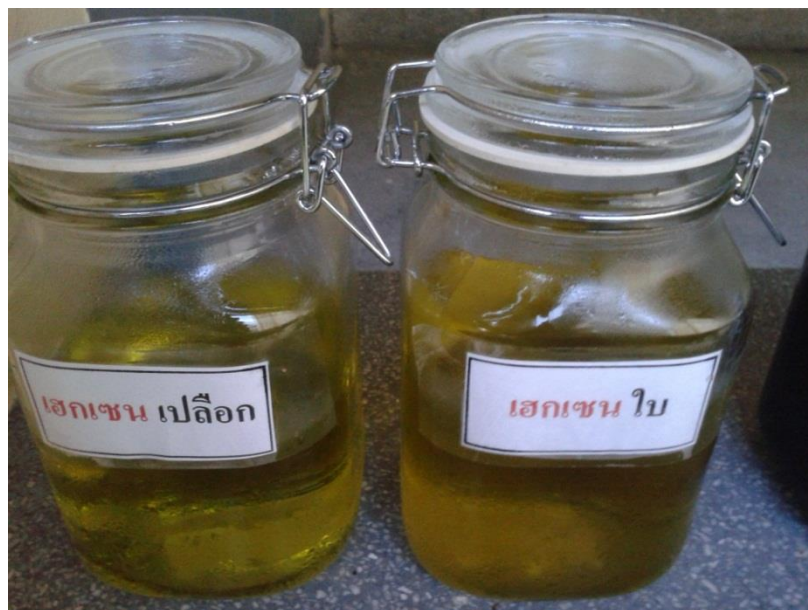
ภาพที่ ข-2 ภาพการสกัดสารสำคัญในใบและเปลือกของต้นผักเหมียง โดยวิธีแช่ด้วยตัวทำละลาย เฮกเซน
