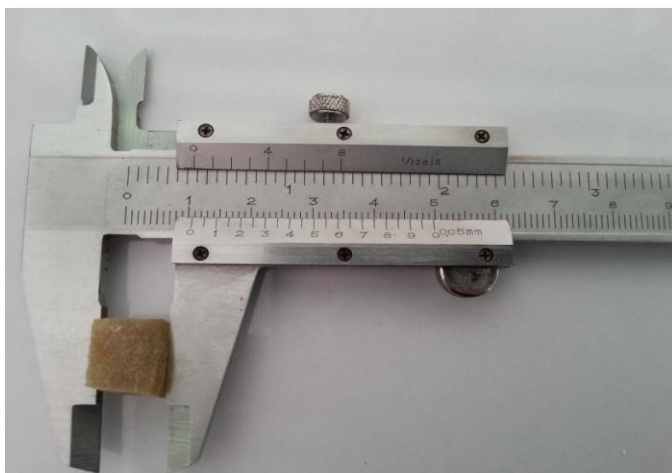
ภาพที่ 17 การวัดขนาดของกรือโป๊ะ โดยใช้เวอร์เนียคาร์ลิปเปอร์
