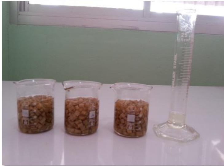
ภาพที่ 18 รินน้ำมันพืชลงในบีกเกอร์ที่บรรจุกรือโป๊ะให้มีระดับเท่ากับระดับกรือโป๊ะ
