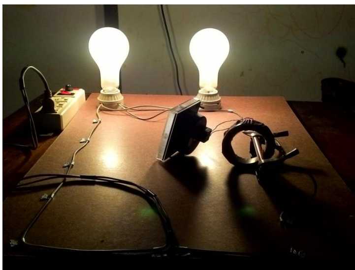
ภาพที่ 13 การวัดกระแสไฟฟ้าจาก Current Transformer เพื่อนำมาคำนวณหาอัตราส่วน
