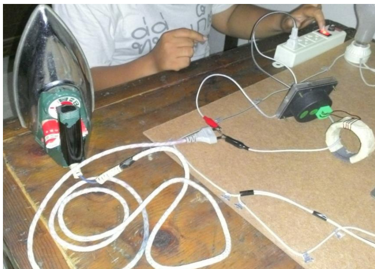
ภาพที่ 15 แสดงการวัดกระแสไฟฟ้าของเตารีดด้วย Current Transformer
