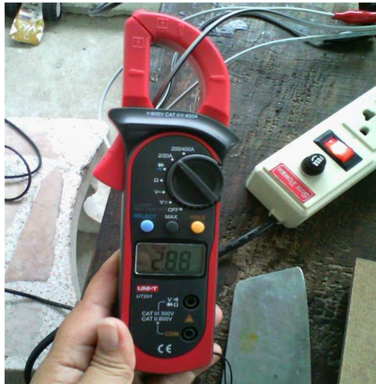
ภาพที่ 18 การวัดกระแสไฟฟ้าจากดิจิตอลแคลมป์มิเตอร์
