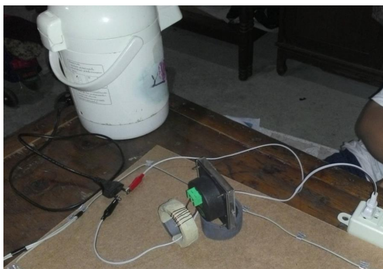
ภาพที่ 16 แสดงการวัดกระแสไฟฟ้าของกาต้มน้ำไฟฟ้าด้วย Current Transformer
