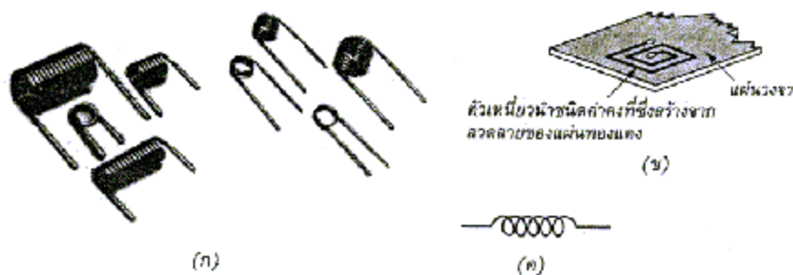
ภาพที่ 7 ลักษณะตัวเหนี่ยวนำแกนอากาศ
