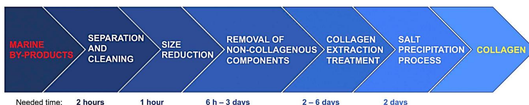
ภาพที่ 2 ขั้นตอนโดยสรุปสำหรับการสกัดคอลลาเจน (Salvatore et al., 2020)
