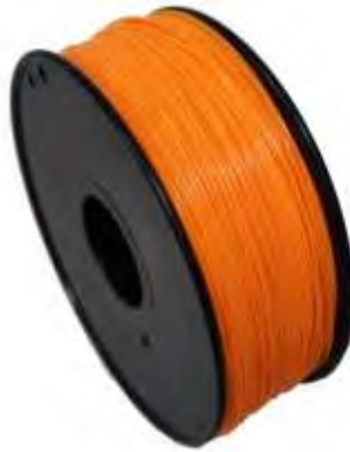
ภาพที่ 2-9 เส้นพลาสติกประเภท ABS (Acrylonitrile Butadiene Styrene)
