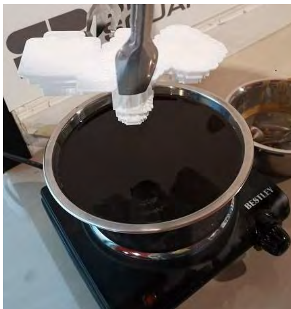
ภาพที่ 3-18 ชุบเคลือบ ใช้เวลาประมาณ 1 วินาที ที่มา: เกรียงศักดิ์ เขียวมั่ง
