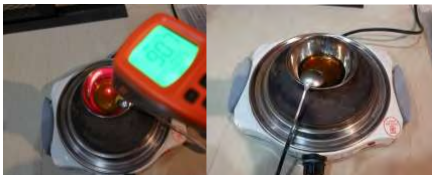
ภาพที่ 3-6 ตรวจสอบอุณหภูมิที่ใช้ในการหลอม (ซ้าย) ส่วนผสมหลอมละลายและเข้ากันดีแล้ว (ขวา) ที่มา: เกரியงศ์ศักดิ์ เขียวมั่ง
