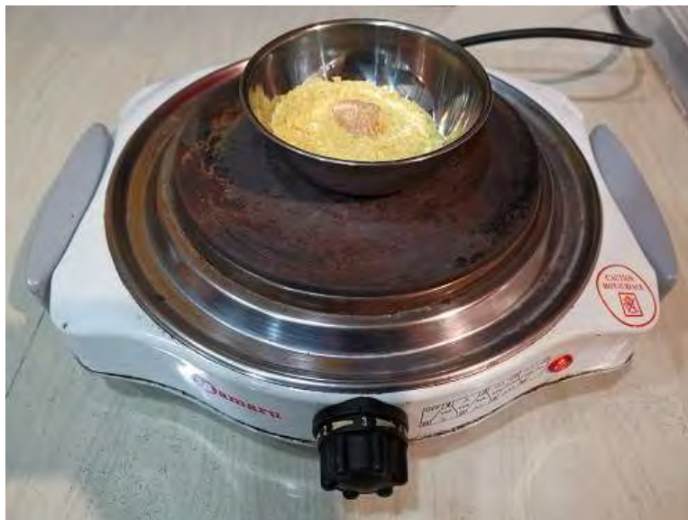
ภาพที่ 3-5 เตาไฟฟ้าสำหรับการหลอมละลายส่วนผสมวัตถุดิบ ที่มา: เกரியงศ์ศักดิ์ เขียวมั่ง
