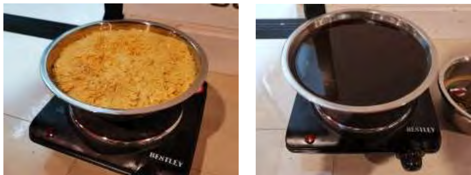
ภาพที่ 3-17 เตรียมอุณหภูมิเคลือบ (ซ้าย) เคลือบที่หลอมละลายและส่วนผสมเข้ากันดีแล้ว (ขวา) ที่มา: เกรียงศักดิ์ เขียวมั่ง
