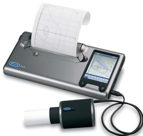
รูปที่ 8 เครื่องวัดสมรรถภาพและความจุปอด รุ่น (MicroLab, Micro Medical®, USA)
