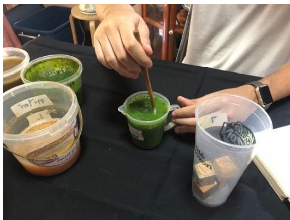
ภาพที่ 4-7 การผสมสูตรสารสกัด โดยทฤษฎีเส้นตรง (Line Blend)
