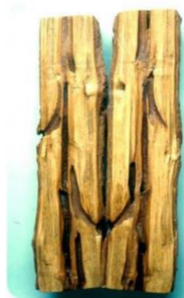
ภาพที่ 2-15 ความเสียหายของเนื้อไม้สัก ที่เกิดจากการเจาะของหนอนเจาะต้นสัก (สำนักวิจัยและพัฒนาการป่าไม้ กรมป่าไม้, 2556)
