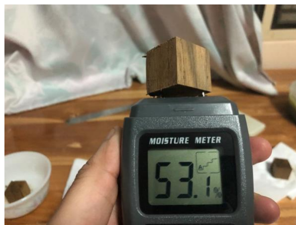
ภาพที่ 4-17 การวัดความชื้นตัวอย่างทดลองที่ผ่านการทดลองการดูดซึมสารสกัดสมุนไพรด้วยหม้อแรงดัน
