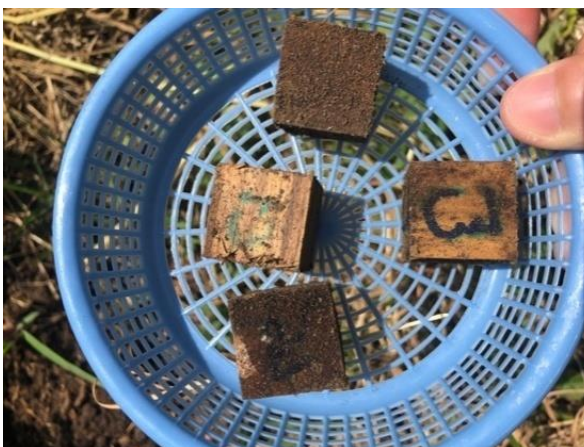
ภาพที่ 4-13 ตัวอย่างทดลองไม้สักอายุน้อยที่ผ่านการฝังในจอมปลวก
