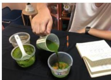
ภาพที่ 3 นำตัวอย่างทดลองแช่ลงในสูตรสารสกัดสมุนไพร 7 วัน
