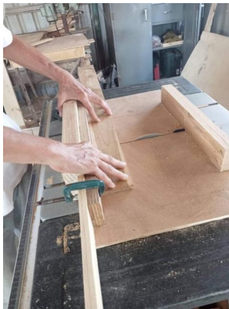
ภาพที่ 5-18 การผลิตต้นแบบผลิตภัณฑ์หิ้งพระจากไม้สักอายุน้อยชีวภาพ
