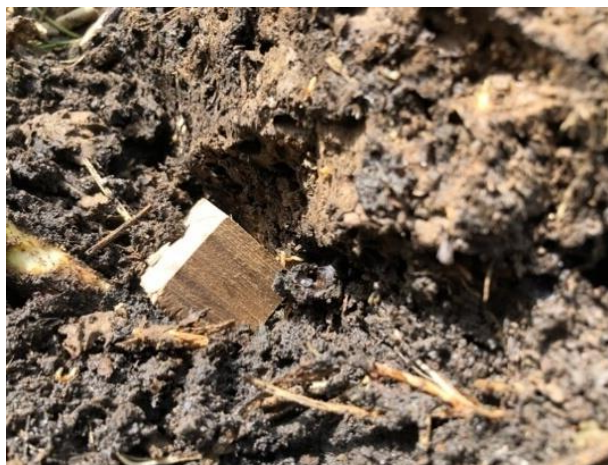
ภาพที่ 4-12 การฝังตัวอย่างทดลองไม้สักอายุน้อยในจอมปลวก
