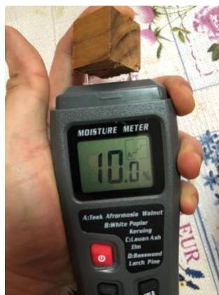
ภาพที่ 4-14 การวัดค่าความชื้นของตัวอย่างทดลองไม้สักก่อนการนำไปทดลองการดูดซึมสารสกัดสมุนไพรด้วยหม้อแรงดัน
