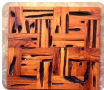
ภาพที่ 2-16 ความเสียหายของเนื้อไม้สัก ที่เกิดจากการเจาะของหนอนเจาะต้นสัก ( สำนักวิจัยและ พัฒนาการป่าไม้ กรมป่าไม้, 2556 )
