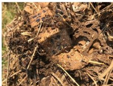
ภาพที่ 4 นำตัวอย่างทดลองที่ผ่านการแช่สารสกัดสมุนไพร ไปใส่ลงในจอมปลวกเป็นเวลา 1 เดือน
