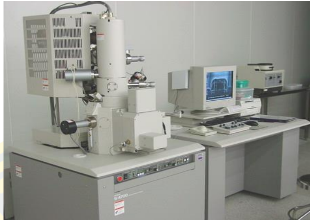
ภาพที่ 26 เครื่อง Field Emission Scanning Electron Microscope (FE-SEM)
