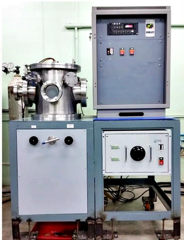
ภาพที่ 24 เครื่องเคลือบสุญญากาศระบบรีแอคทีฟดีซีแมกนีตรอนสเปคเตอรिंगที่ใช้ในงานวิจัย
