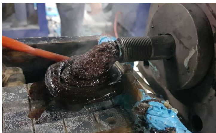
ภาพที่ 19 ลักษณะการไหม้ในเครื่องหลอมอัดรีดของไบโอคอมโพลีเมอร์ PLADB30 และ PLAPL30
