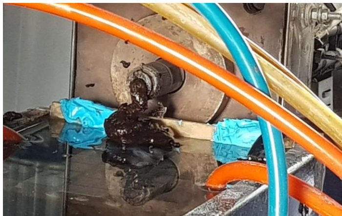
ภาพที่ 18 ลักษณะการอุดต้นในเครื่องหลอมอัดรีดของคอมโพลีเมอร์ PLADB30 และ PLAPL30
