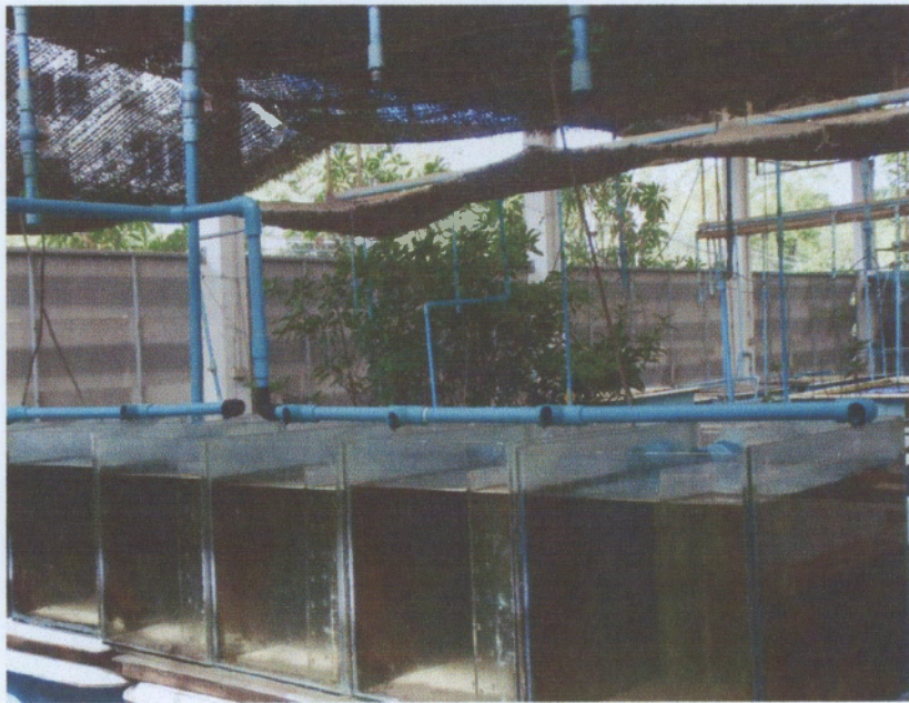
ภาพที่ 3.6 ตู้ทดลองที่ต่อเชื่อมกับระบบกรองภายนอกที่มีการหมุนเวียนน้ำ 24 ชั่วโมง
