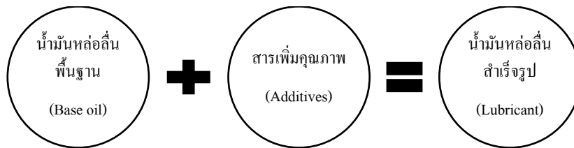
ภาพที่ 2-1 ส่วนประกอบของน้ำมันเครื่องยนต์
