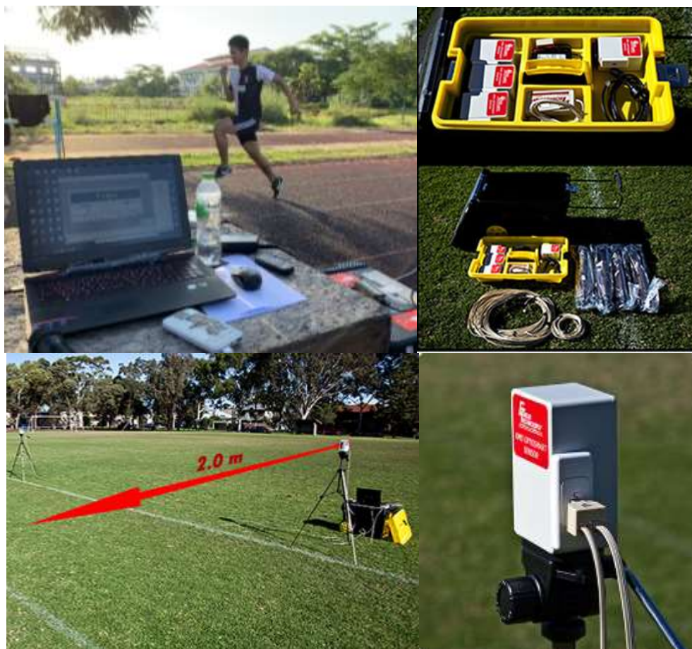
ชุดเครื่องวิเคราะห์การเคลื่อนไหวของร่างกาย Kinematic measurement system (KMS) ยี่ห้อ Fitness Technology ทำจากประเทศ ออสเตรเลีย ใช้ในการทดสอบวัดความเร็ว
