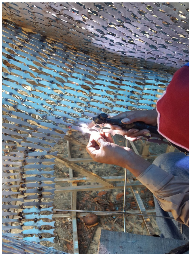
ภาพที่ 4-6 ขั้นตอนการเชื่อมอาร์กอน
