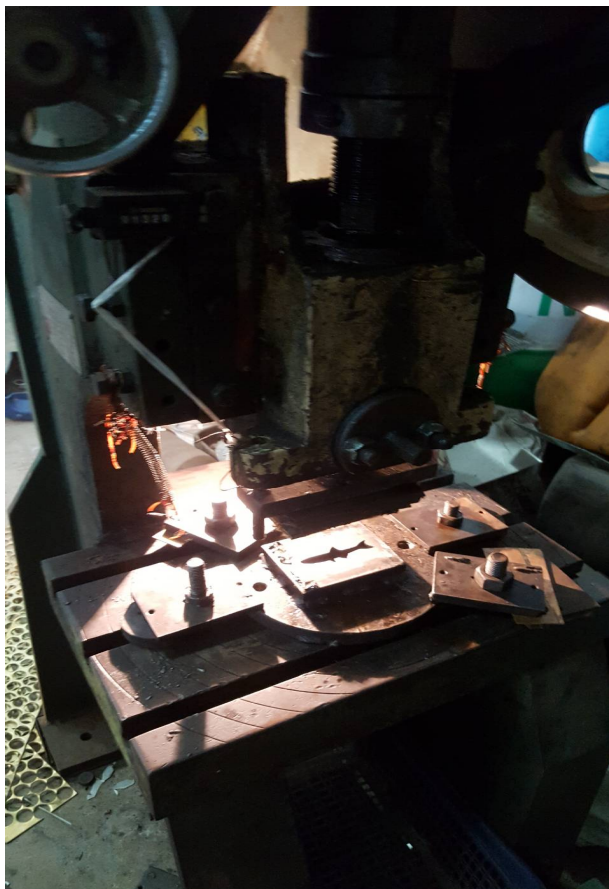
ภาพที่ 4-4 พิมพ์ตัดยึดกับแท่นเครื่องตัด
