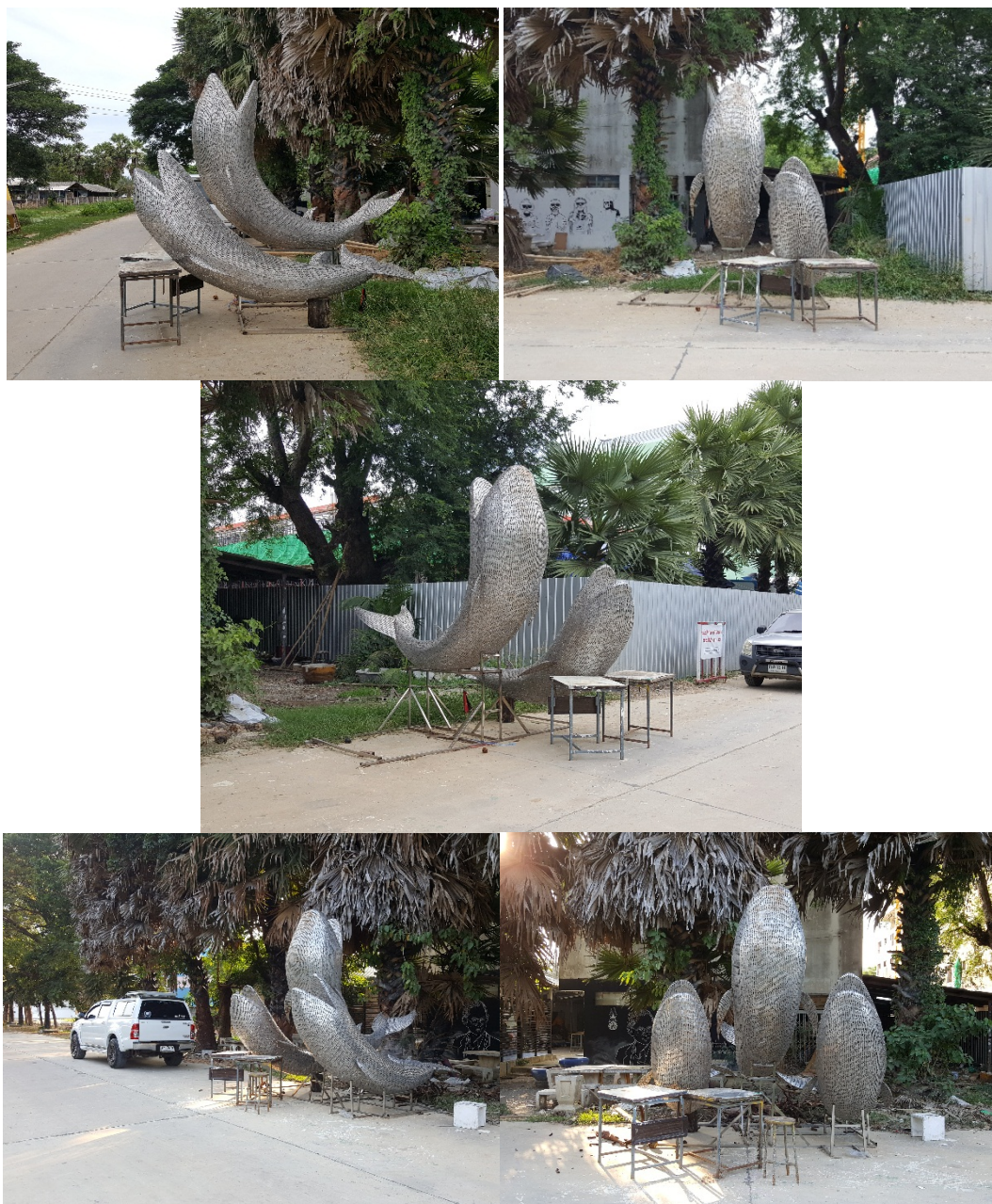
ภาพที่ 4-9 ชิ้นผลงานสแตนเลสที่เชื่อมสำเร็จกำลังเตรียมประกอบยึดกับฐาน
