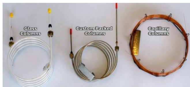
ภาพที่ 2-17 คอลัมน์สำหรับเครื่องแก๊สโครมาโทกราฟี (Tek-Lab, 2015)
