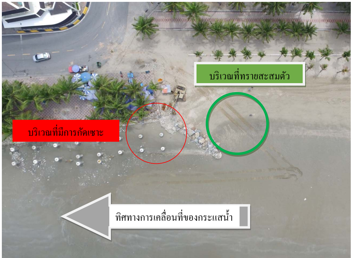
ภาพที่ 5-3 การสะสมของตะกอนทรายบริเวณรอดักทรายของพื้นที่แหลมแท่น ช่วงมรสุมตะวันตกเฉียงใต้ ถ่ายเมื่อวันที่ 23 สิงหาคม พ.ศ. 2558
