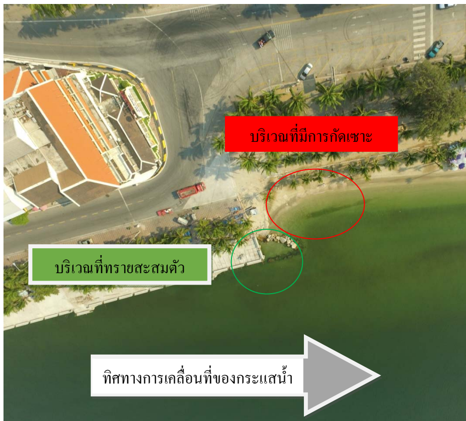
ภาพที่ 5-4 การสะสมของตะกอนทรายบริเวณรอดักทราย ของพื้นที่แหลมแท่น ช่วงมรสุมตะวันออกเฉียงเหนือ ถ่ายเมื่อวันที่ 10 มกราคม พ.ศ. 2559
