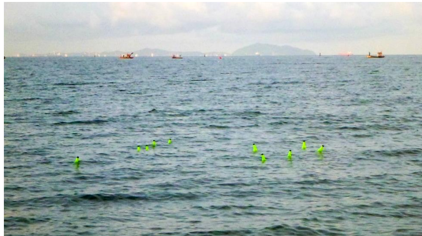
ภาพที่ 2 ลักษณะของขวดน้ำอัดลมพลาสติกที่ถูกปล่อยลงสู่ทะเลเพื่อศึกษากระแสน้ำชายฝั่ง
