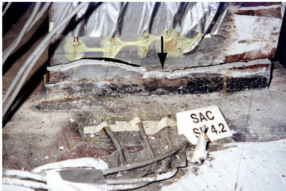
รูปที่ 4.10 แสดงลักษณะการแตกของปีกคานด้านผิวบน ที่บริเวณ Access Hole ของชิ้นงานทดสอบ
