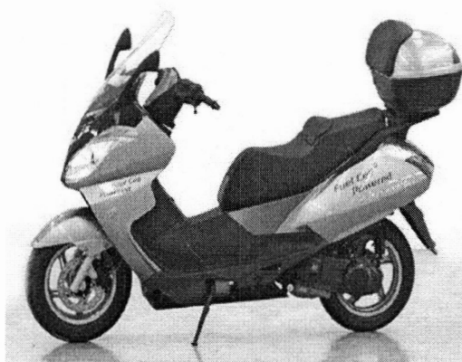
รูปที่ 1.3 ฟลูเซลล์ใช้ในการให้พลังงานกับโทรทัศน์และเครื่องเล่นวีดีโอ (กำลังขนาด 100 วัตต์) และงานขับเคลื่อนรถยนต์ และรถมอเตอร์ไซด์
