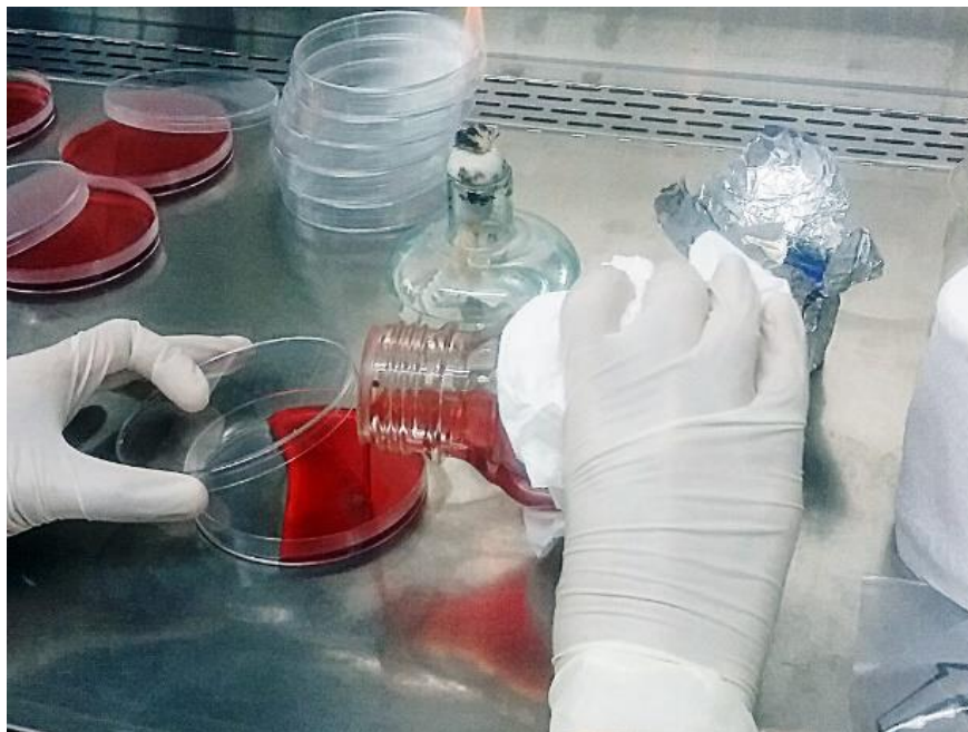
รูปที่ ข.1 การเตรียมอาหารเลี้ยงเชื้อแบบแข็ง
