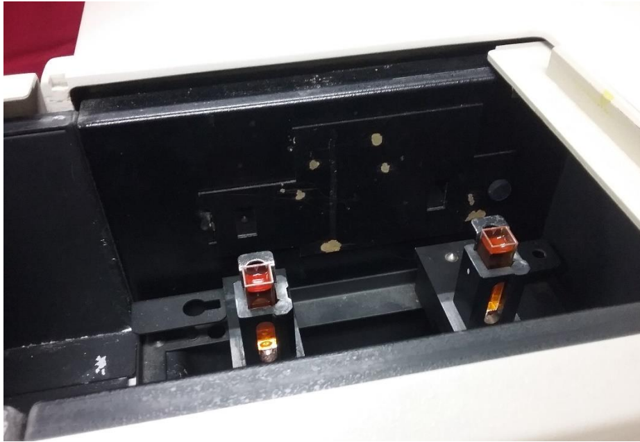
รูปที่ ข.3 ทดสอบปริมาณน้ำตาลกลูโคสด้วยเครื่อง Spectrophotometer
