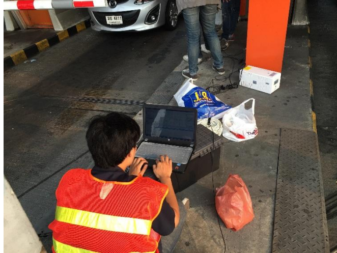
ภาพที่ 3.14 การเชื่อมต่อระหว่างเครื่องรวมสัญญาณความถี่สูงแบบหลายช่องสัญญาณ (High frequency multi-channel data acquisition unit) เข้ากับคอมพิวเตอร์
