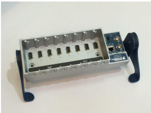
ภาพที่ 3.5 เครื่องรวมสัญญาณความถี่สูงแบบหลายช่องสัญญาณ (High frequency multi-channel data acquisition unit)
