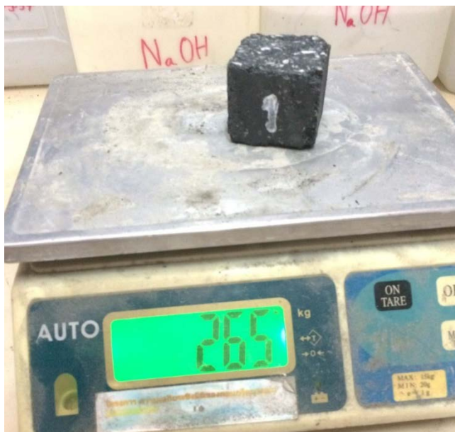
รูปที่ 3.25 การชั่งน้ำหนักตัวอย่างคอนกรีตบดหลังจากแช่น้ำ
