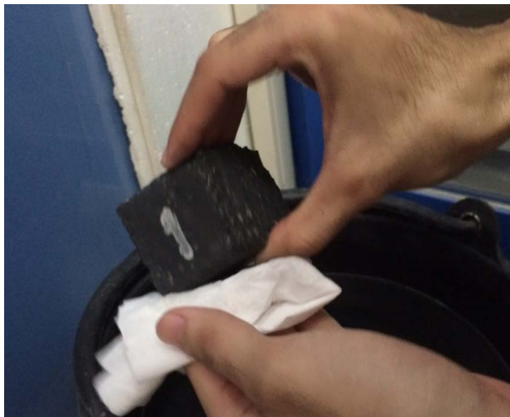
รูปที่ 3.24 การเช็ดผิวคอนกรีตบล็อกให้แห้ง
