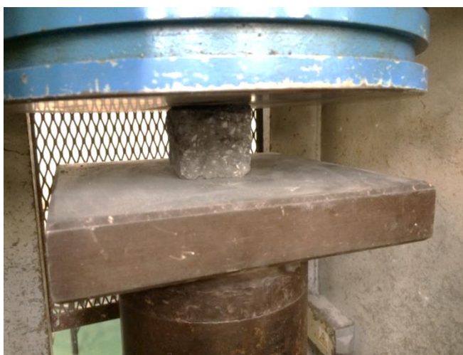
รูปที่ 3.19 การทดสอบค่าลึงอัดของตัวอย่างคอนกรีตบล็อก
