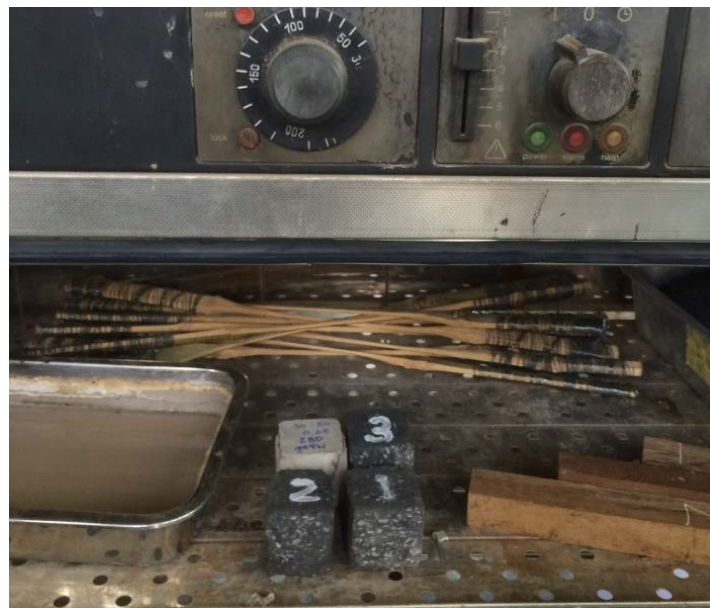
รูปที่ 3.22 การอบคอนกรีตบล็อกที่อุณหภูมิ 105 - 110 °ซ
