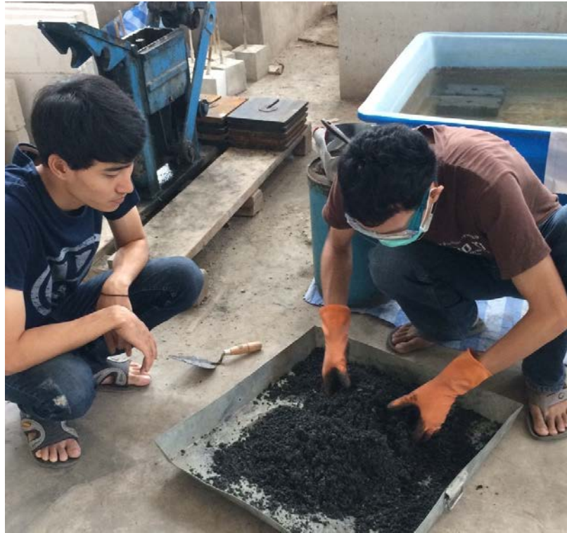
รูปที่ 3.12 การผสมคอนกรีตบล็อก
