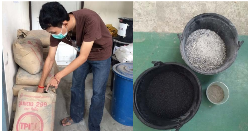
รูปที่ 3.10 การเตรียมวัสดุผสมคอนกรีตบล็อก
