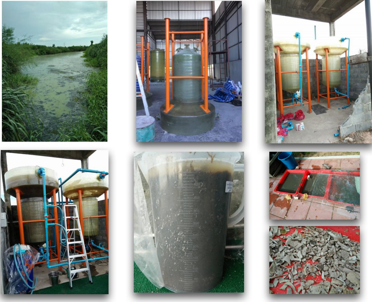
รูปที่ 5-4 แสดงการติดตั้งระบบต้นแบบผลิตปุ๋ยสตรูไวท์
