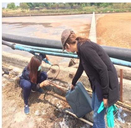
เก็บน้ำเสียก่อนเข้าไปโอแก๊ส
