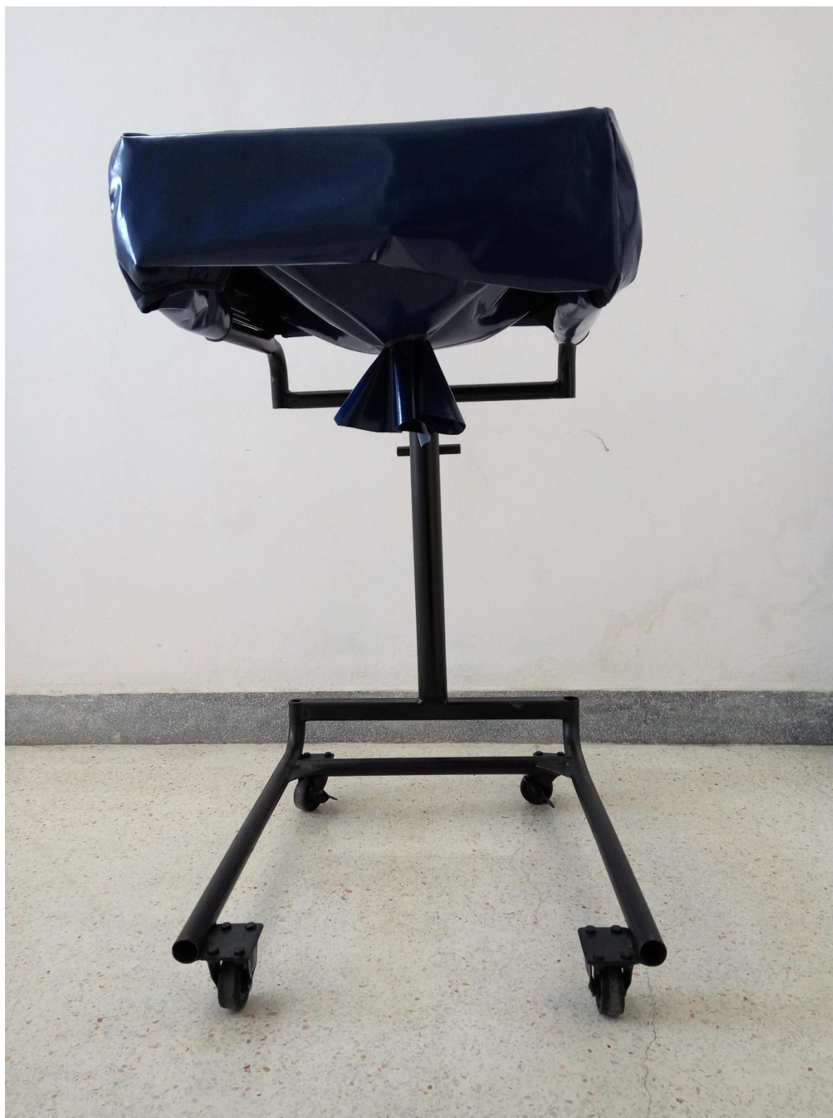
ภาพที่ 1.9 ภาพถ่ายชิ้นงานด้านหน้าของอุปกรณ์ป้องกันทารกพลัดหล่นในการฝึกทำคลอดทารก แบบที่ 1 เมื่อสวมผ้าใบเคลือบ pvc
