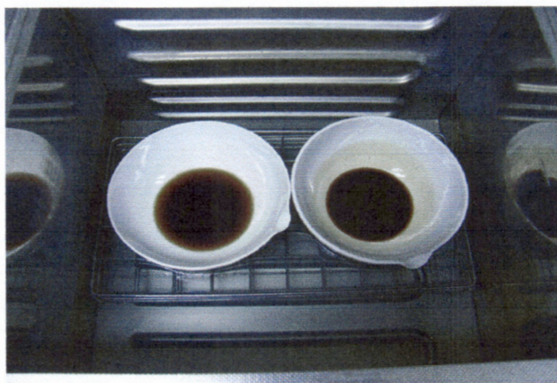
ค) ระเหยน้ำออกที่อุณหภูมิ 40 องศาเซลเซียสในอ่างควบคุมอุณหภูมิ
