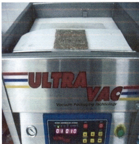
(ข) การบรรจุข้าวด้วยเครื่องบรรจุแบบ สุญญากาศ
