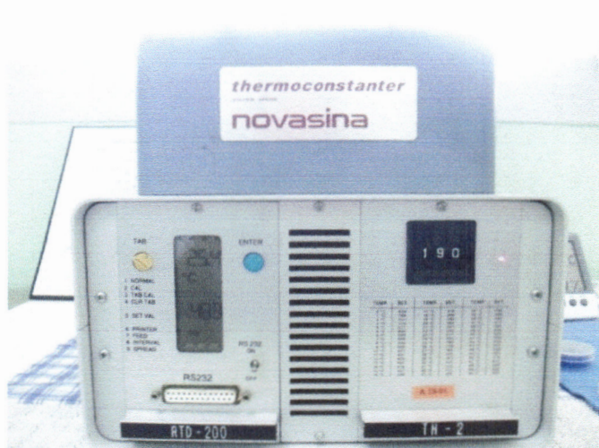
ภาพที่ ข-11 เครื่องวัดค่า Water activity (aw)
