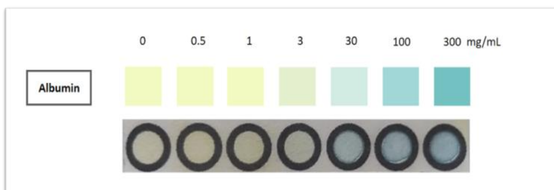
ภาพที่ 4.5 ชุดทดสอบแบบหยดและการอ่านแปลผลของชุดตรวจวัดปริมาณโปรตีนอัลบูมินเชิงกึ่งปริมาณ 0-300 mg/mL
