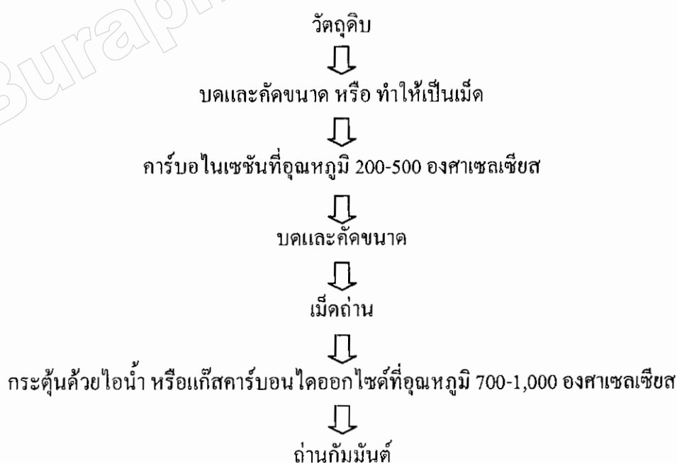
ภาพที่ 2-1 สรุปขั้นตอนการผลิตถ่านกัมมันต์ด้วยวิธีการกระตุ้นเชิงกายภาพ
