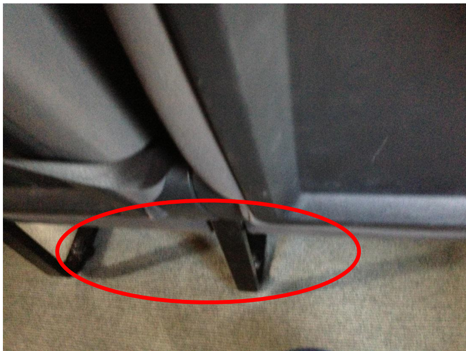
ภาพที่ 4-15 การยึดเบาะที่นั่งติดกับพื้นรถ
