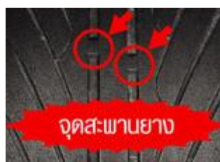
ภาพที่ 2-27 ความลึกของดอกยางเหลือ 1.6 มิลลิเมตร (ดอกยางสึกร้อยละ 80) (โยโกฮามา ไรร์ เซลส์ (ประเทศไทย), 2556)
