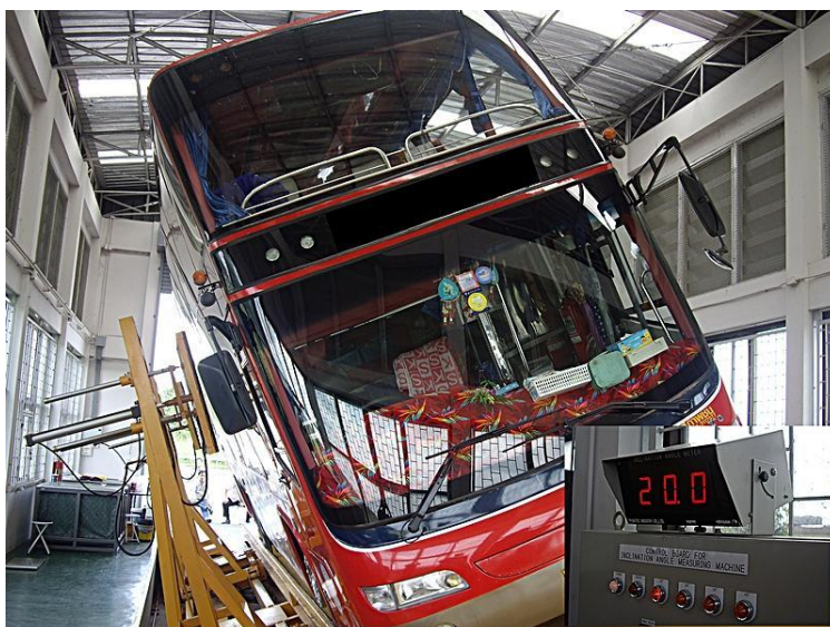
ภาพที่ 2-31 รถกำลังทดสอบการทรงตัวที่ระดับ 20 องศา (สมาคมผู้ประกอบการรถขนส่งทั่วไทย, 2555)
