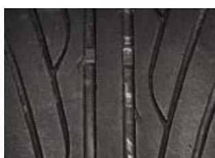
ภาพที่ 2-26 ความลึกของดอกยางเหลือ 4 มิลลิเมตร (ดอกยางสึกร้อยละ 50) (โยโกฮามา ไทร์ เซลส์ (ประเทศไทย), 2556)
