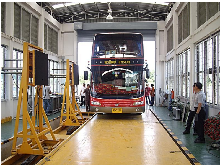
ภาพที่ 2-30 รถเตรียมทดสอบการทรงตัว (สมาคมผู้ประกอบการรถขนส่งทั่วไทย, 2555)
