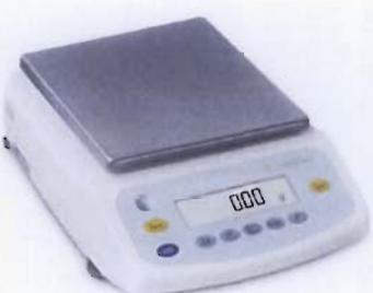
ภาพที่ 3-3 เครื่องซั่งน้ำหนักแบบดิจิตอล
