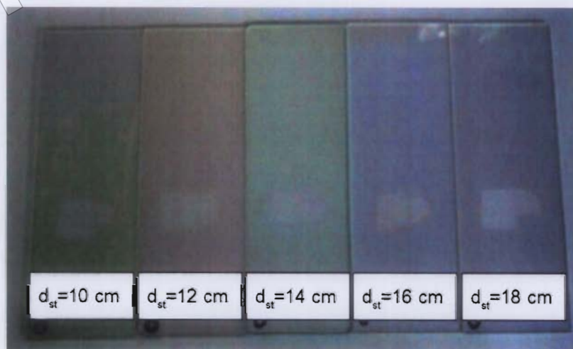
ภาพที่ 4-1 ลักษณะของฟิล์มบางไทเทเนียมไดออกไซด์ที่เคลือบบนกระจกสไลด์ เมื่อเคลือบด้วยระยะห่างระหว่างเป้าสารเคลือบกับวัสดุรองรับต่าง ๆ
