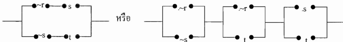
ข้อสังเกต เราจะพบว่า มีสวิตช์ตัวหนึ่งที่เขียนแทนด้วย  $\sim r$  ทั้งๆ ที่ไม่มีสวิตช์ใดเขียนแทนด้วย  $r$  เลย ดังนั้น เราจะเขียนแทน  $\sim r$  ด้วย  $r$  และฟังก์ชันที่สอดคล้องกับวงจรนี้ คือ  $F = (r \otimes s) \oplus (\sim s \otimes t)$  หรือ  $F = (r \oplus \sim s) \otimes (r \oplus t) \otimes (s \oplus t)$
