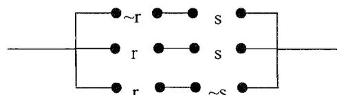
นอกจากนี้ จะเห็นได้ว่า กระแสไฟฟ้าจะไม่ไหลผ่านวงจร ( $F = 0$ ) เมื่อ  $r = s = 0$
