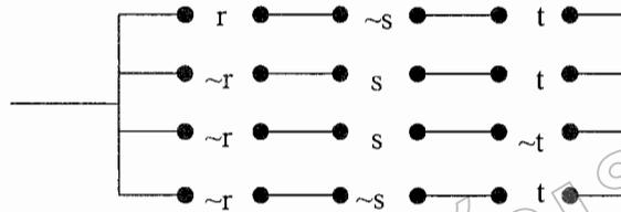
นอกจากนี้ จะเห็นได้ว่า กระแสไฟฟ้าจะไม่ไหลผ่านวงจร ( $F=0$ ) เมื่อแต่ละข้อต่อไปนี้เป็นจริง
