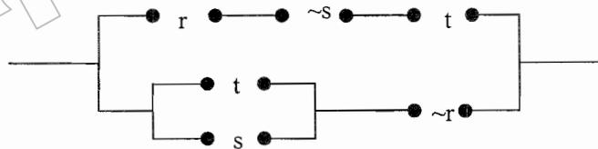
จะได้ ฟังก์ชันที่สอดคล้องกับวงจรนี้ คือ  $F = (r \otimes \sim s \otimes t) \oplus ((t \oplus s) \otimes \sim r)$
