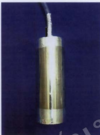
ภาพที่ ข-1 ภาชนะโลหะที่ปิดสนิทที่มีท่อต่อสำหรับวัดความดัน
