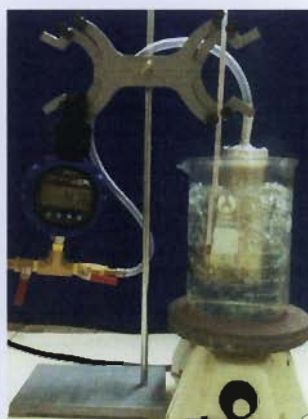
ภาพที่ 7 น้ำในภาชนะถูกต้มให้เดือดโดยใช้เตาความร้อน ให้ความร้อนกับอากาศที่มีอยู่ในภาชนะโลหะ
