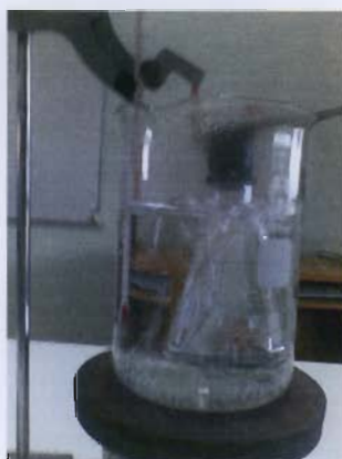
ภาพที่ 3 ขวดรูปชมพู่ ที่รักษาความดันในหลอดแก้วให้อยู่ที่ความดันบรรยากาศ อยู่ในภาชนะที่มีน้ำกำลังเดือด
