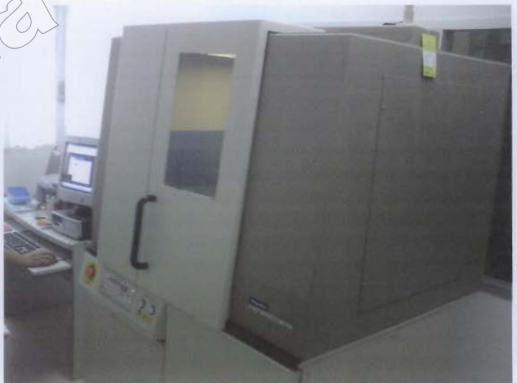
ภาพที่ 3-2 เครื่องเคลือบสุญญากาศระบบรีแอคทีฟ ดีซี แมกนีตรอน สปีดเตอร์ที่ใช้ในงานวิจัย
