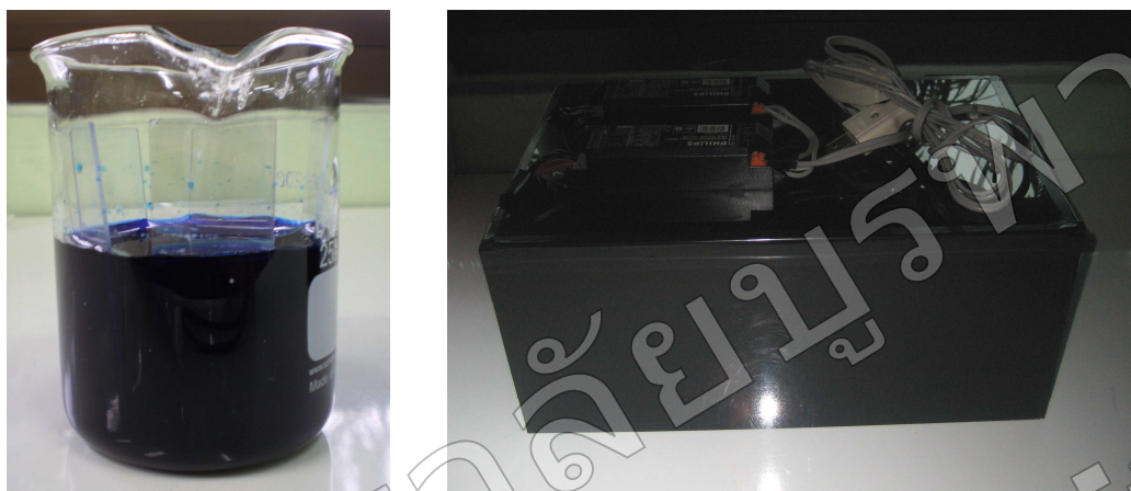
ภาพที่ 3-14 การแช่ฟิล์มในสารละลายเมทิลีนบลูความเข้มข้น 1 mmol/l และกล่องสำหรับฉายแสงยูวี
