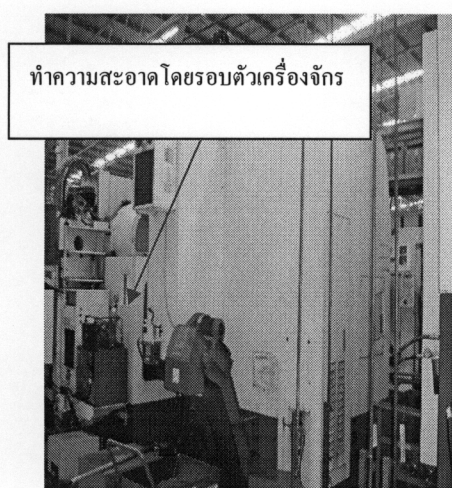
ภาพที่ 4-9 ตำแหน่งในการบำรุงรักษาเครื่องจักร M/C 10-3 รายการที่ 10
