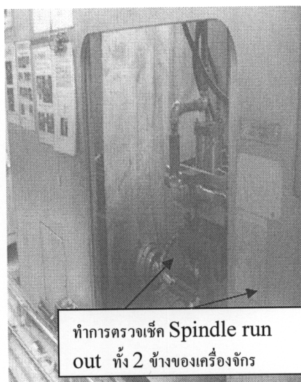
ภาพที่ 4-2 ตำแหน่งในการบำรุงรักษาเครื่องจักร M/C 20-4 รายการที่ 7
