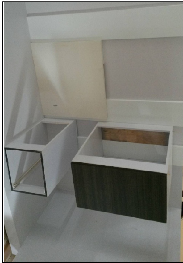
ภาพที่ 4-27 ทำระบบโมดูลาร์ล๊อคและนำโครงตู้มาติดตั้งเพื่อทดสอบการรับน้ำหนัก
