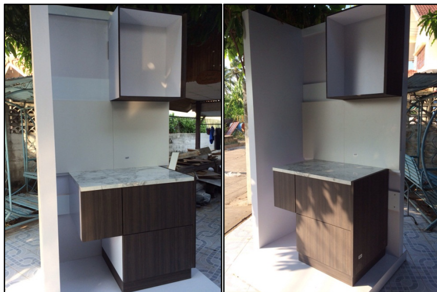
ภาพที่ 4-28 นำตู้ที่เสร็จบางส่วนมาทดสอบระบบโมดูลาร์ล๊อค
