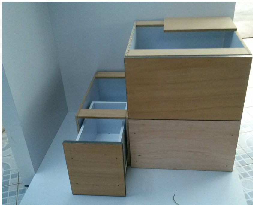
ภาพที่ 4-26 นำโครงที่ประกอบเสร็จมาวางเพื่อวัดขนาดทำระบบโมดูลาร์ล็อก
