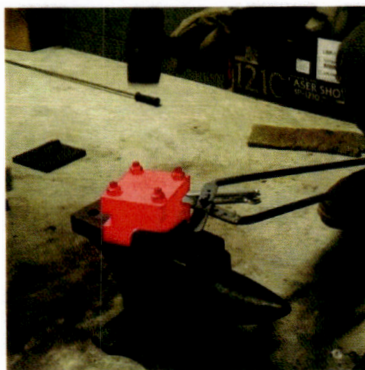
รูปที่ 9 การทุบแคมป์เหล็กหลังนำออกจากเตาไฟฟ้า
