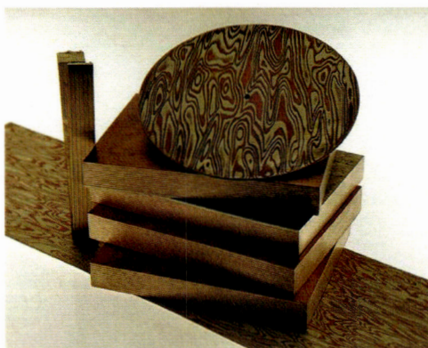
รูปที่ 3 แท่งโลหะที่เชื่อมติดกันเรียบร้อยแล้ว และแผ่นโมกูเมกานะ ( http://www.orafaabc.com/Gallery.Mokume.html )
