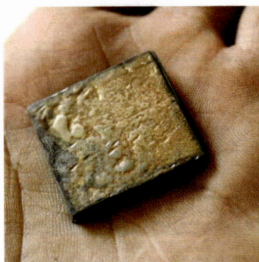
รูปที่ 10 แท่งโลหะที่เชื่อมติดกัน
