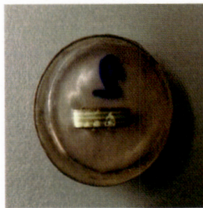
รูปที่ 17 การหล่อเรซินชิ้นงานโลหะ
