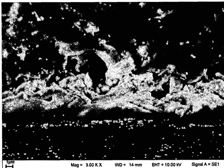
รูปที่ ก-24 ภาพถ่ายรอยต่อของชั้นงานทองแดง/เงินสเตอร์ลิง อบที่อุณหภูมิ 700 °C ระยะเวลา 3 ชั่วโมง จากกล้องจุลทรรศน์อิเล็กตรอนแบบส่องกราด กำลังขยาย 3,000 เท่า
