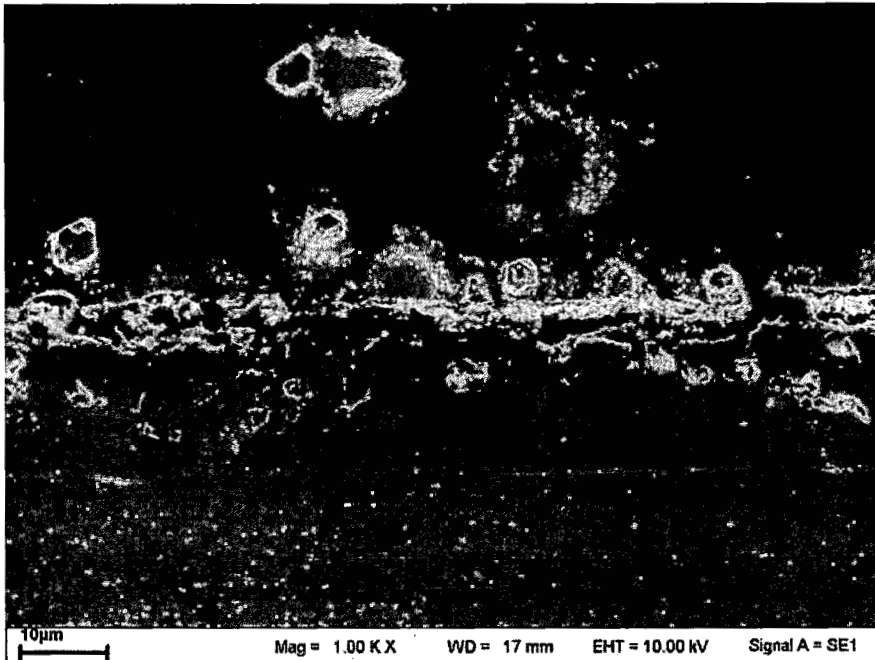
รูปที่ ก-11 ภาพถ่ายรอยต่อของชิ้นงานทองเหลือง/เงินสเตอร์ลิง อบที่อุณหภูมิ 720 °C ระยะเวลา 3 ชั่วโมง จากกล้องจุลทรรศน์อิเล็กตรอนแบบส่องกราด กำลังขยาย 1,000 เท่า
