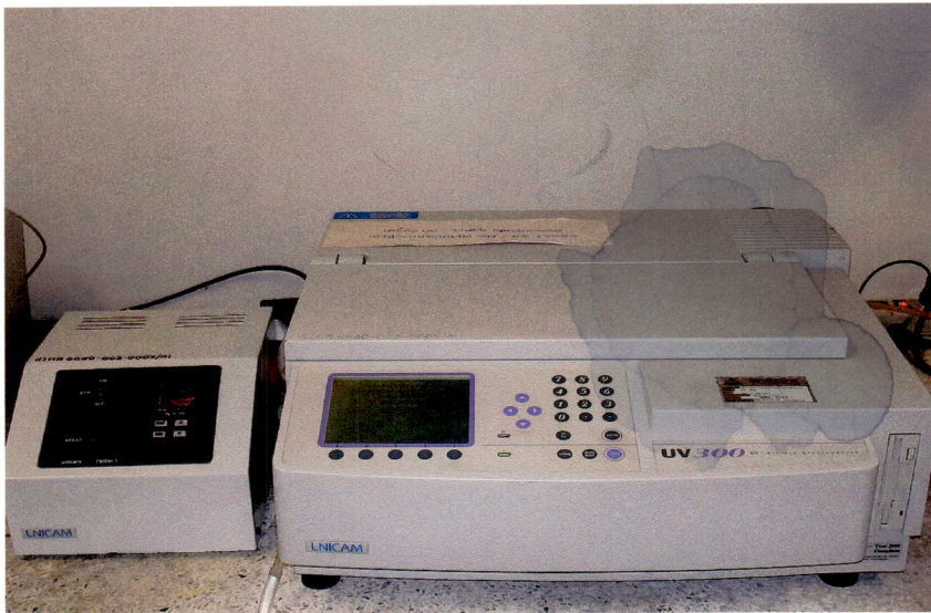
ภาพที่ 3.3 เครื่อง UV-visible spectrometer, UV300 และชุดควบคุมอุณหภูมิสำหรับ วัดกิจกรรมการทำงานของเอนไซม์
