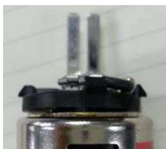
ภาพที่ 3-16 ลักษณะของชิ้นงานที่ฟิวส์ยูนิตประกอบไม่ลงร่อง
