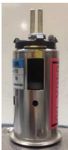
ภาพที่ 5-1 ชิ้นงานตัวแทน (Master) ตรวจจับการทำงานของหัว핀โพรบ
