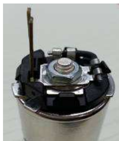
ภาพที่ 3-13 ลักษณะชิ้นงานไม่มีสปริงวอชเซอร์ประกอบ
