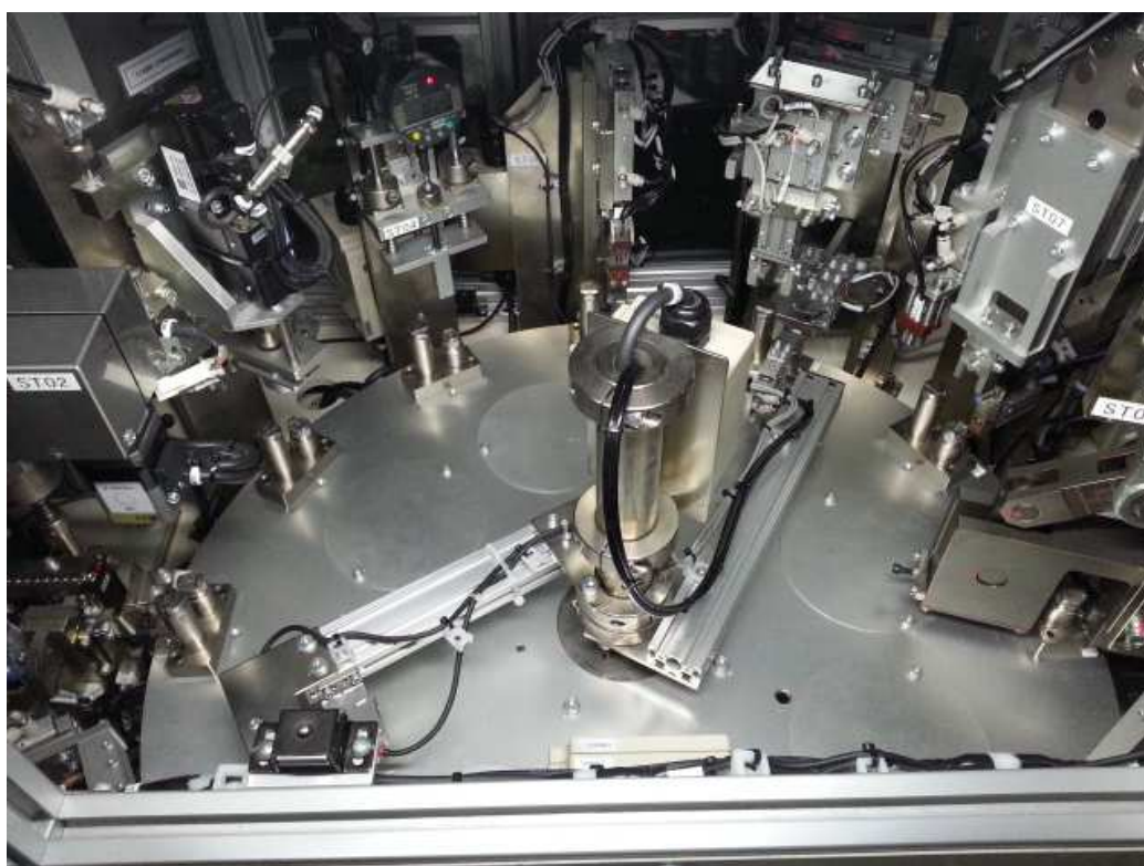
ภาพที่ 3-3 ลักษณะเครื่องจักรที่ประกอบอุปกรณ์จุดบุหรี่ในรถยนต์
