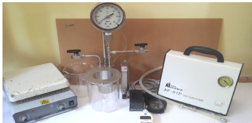
ภาพที่ 4-1 ชุดทดลองเรื่องพลังงานจลน์เฉลี่ยของแก๊ส สำหรับนักเรียนระดับชั้นมัธยมศึกษาตอนปลาย
