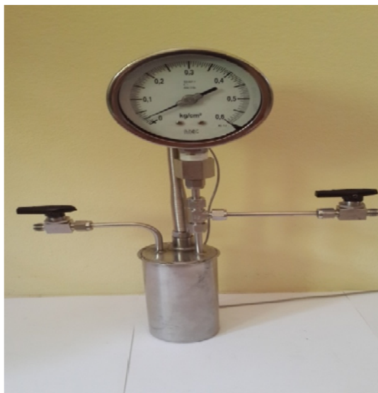
ภาพที่ 4-2 ท่อบรรจุแก๊สและอุปกรณ์ประกอบประเภททาล้างและเกจวัดความดัน
