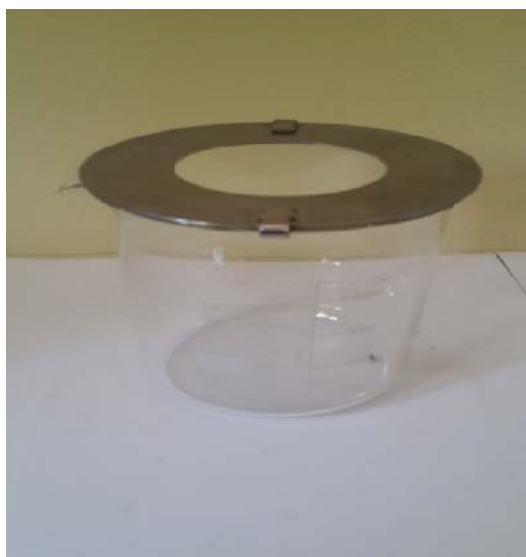
ภาพที่ 4-3 ปีกเกอร์และฐานสำหรับให้ความร้อนกับท่อบรรจุแก๊ส
