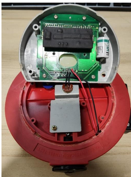
รูปที่ 4.3 การเชื่อมต่อสายสัญญาณจากเครื่องบีบมือกับบอร์ดไมโครคอนโทรลเลอร์ EPS32
