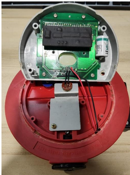
รูปที่ 4.3 การเชื่อมต่อสายสัญญาณจากเครื่องปีบมือกับบอร์ดไมโครคอนโทรลเลอร์ EPS32
