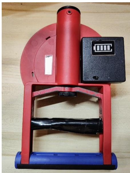
รูปที่ 4.6 การติดตั้งกล่องอุปกรณ์ที่พัฒนากับเครื่องบีบมือเดิม
