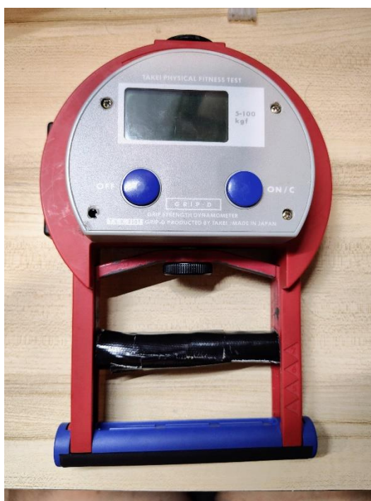
รูปที่ 4.1 เครื่องวัดแรงบีบมือยี่ห้อ Takei®, model 5101 TTK
