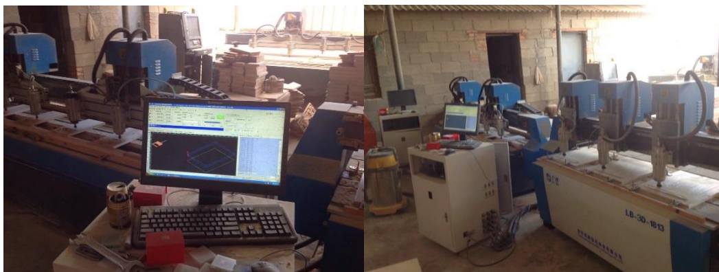
ภาพที่ 5-4 การวาดแบบจำลองในคอมพิวเตอร์และนำไปแกะสลักด้วยเครื่องจักร
