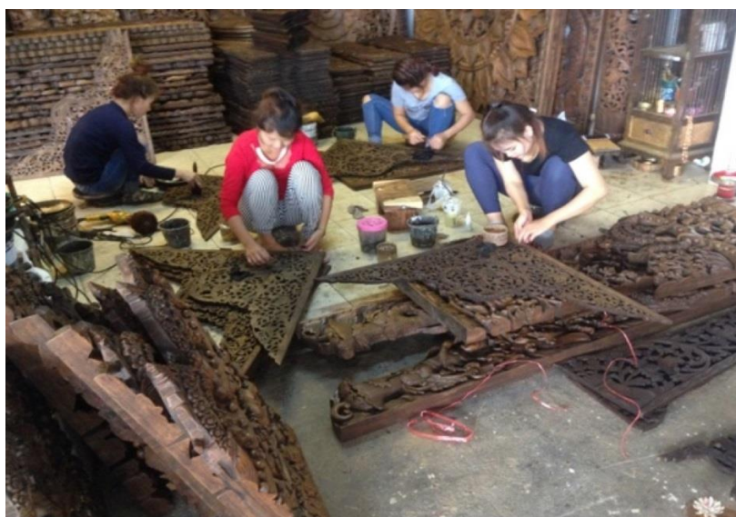
ภาพที่ 4-22 การขัดเงาและเคลือบแลคเกอร์บนผลิตภัณฑ์ไม้แกะสลักบ้านถวาย
